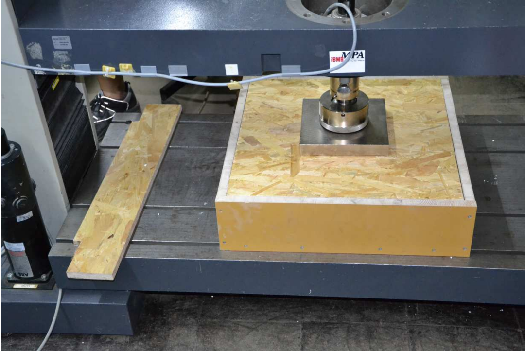
Bild 3: Kasten mit Schüttung, Auflage aus OSB-Platte und mit Prüfstempel in der Prüfmaschine.
