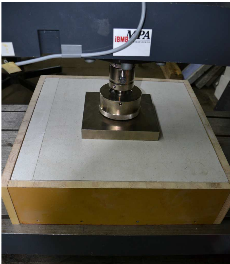
Bild 2: Kasten mit Schüttung, Auflage aus Trockenestrich und mit Prüfstempel in der Prüfmaschine.
